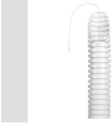
Baureihe von leichten biegsamen Kabelschutzrohren aus PVC, FK9, Klassifizierung 22212, erhältlich in sechs Durchmessern, von 16 bis 50 mm, mit oder ohne Zugdraht, Farbe Grau RAL 7035. Geeignet für elektrische bzw. Datenübertragungssysteme. Empfohlen für die Unterputzinstallation in vertikalen Wänden oder Decken. Die FK9-Rohre entsprechen den Normen EN 61386-1 und EN 61386-22.
