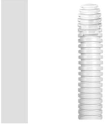
Baureihe von leichten biegsamen Kabelschutzrohren aus PVC, FK9, Klassifizierung 22212, erhältlich in sechs Durchmessern, von 16 bis 50 mm, mit oder ohne Zugdraht, Farbe Grau RAL 7035. Geeignet für elektrische bzw. Datenübertragungssysteme. Empfohlen für die Unterputzinstallation in vertikalen Wänden oder Decken. Die FK9-Rohre entsprechen den Normen EN 61386-1 und EN 61386-22.
