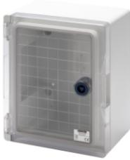
Wassergeschützte Aufputz-Schaltschranke aus Thermoplast GW PLAS 120. Gemäß IEC 61439-1 (CEI 17/113), IEC 61439-2 (CEI 17/114), IEC 60670-1 (CEI 23/48) und IEC 60670-24 (CEI 23/49). Erhältlich in 4 Größen, mit transparenten und geschlossenen Türen in der Schutzart IP55. Verfügbares Zubehör: Abdeckungen mit Ausschnitten und herausnehmbaren Trägern, für Reiheneinbaugeräte und Leistungsschalter bis 160A. Geeignet für Automation und Verteilung.
