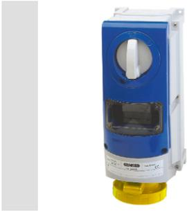
Eine Baureihe aus Industriesteckdosen gemäß IEC 60309, mit Drehschalter und mechanischer Verriegelung, für individuelle Lösungen auf Montagegehäusen. Die Robustheit der Produkte und die Widerstandsfähigkeit gegen chemische und atmosphärische Stoffe, gemeinsam mit der hohen Schutzart IP66, lässt die Montage in rauen Umgebungen zu, mit kritischen atmosphärischen, chemischen und mechanischen (Stoßgefahr) Bedingungen.
