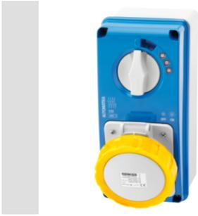
Industriesteckdosen gemäß IEC 309, mit mechanischer Verriegelung und Schutzschalter, erlauben das Stecken oder Ziehen des Steckers nur im ausgeschalteten Zustand und das Schalten nur bei eingestecktem Stecker. Umfangreiche Baureihe mit Drehschaltern, Sicherungssockeln, AUTOMATIKA mit 6kA LS-Schalter C Charakteristik und Versionen mit Sicherheitstrafos. Vielseitig einsetzbar durch Auf- und Unterputzgehäuse, sowie Flansche für die Montage in die Baureihe 68 Q-DIN und 68 Q-MC.
