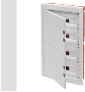
Die geschützten Unterputzverteiler IP40 sind von 2 bis 72TE erhältlich, mit transparenter Rauchglastür (besonders geeignet für Zweckbau und Industrie) oder mit geschlossener Tür (ideal für den Wohnungsbau). Es können ein- und zweipolige 80 A und 125 A Schraub-Klemmleisten montiert werden; Sie ermöglichen eine einfache und übersichtliche Verdrahtung und verkürzen die Montagezeit.
