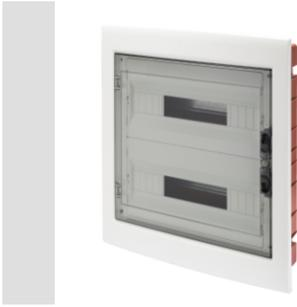
Die geschützten Unterputzverteiler IP40 sind von 2 bis 72TE erhältlich, mit transparenter Rauchglastür (besonders geeignet für Zweckbau und Industrie) oder mit geschlossener Tür (ideal für den Wohnungsbau). Es können ein- und zweipolige 80 A und 125 A Schraub-Klemmleisten montiert werden; Sie ermöglichen eine einfache und übersichtliche Verdrahtung und verkürzen die Montagezeit.
