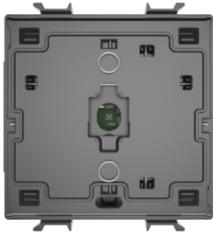
Unterputz Axialer Einwegscharer Modul. Eine axiale Drucktaste auf der Vorderseite zum Schalten einer Last (bistabile/monostabilee Funktion) oder einer zeitgesteuerten Last über einen Ausgangskontakt mit Potential. Das Gerät muss mit den Tasten auf der Vorderseite vervollständigt werden. Das Gerät verfügt über N°3 DIP-Schalter, die sich auf der Rückseite des Geräts befinden und die Konfiguration der Funktionen ermöglichen.
