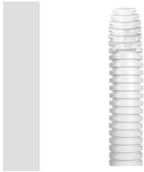
Conduits cintrables légers de la gamme FK9, en PVC, classés 22212, disponibles en six diamètres, de 16 à 50 mm, avec ou sans extracteur de câble, gris RAL 7035. Convient aux systèmes électriques et/ou de transmission de données. Recommandés pour une installation encastrée dans des murs verticaux ou des plafonds. Les conduits FK9 sont conformes aux normes EN 61386-1 et EN 61386-22.
