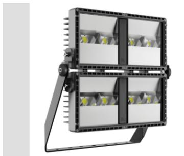
SMART[PRO]e 4M è un proiettore LED di alta potenza, per esterno e interno, adatto all'illuminazione di aree e impianti sportivi di medie dimensioni. Può essere installato a parete, a soffitto o a terra grazie alla staffa in acciaio zincato verniciato a polvere di poliestere con passivazione trivalente dotata di scala goniometrica regolabile, fornita in kit.
