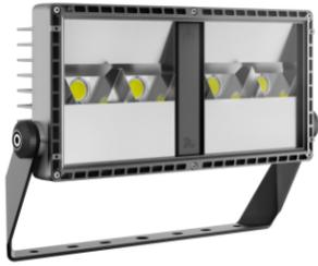
SMART[PRO]e 2M è un proiettore LED di media potenza, per esterno e interno, adatto all'illuminazione di aree e impianti sportivi di piccole e medie dimensioni. Può essere installato a parete, a soffitto o a terra grazie alla staffa in acciaio zincato verniciato a polvere di poliestere con passivazione trivalente dotata di scala goniometrica regolabile, fornita in kit.
