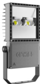
SMART[PRO]e 1M è un proiettore LED di media potenza, per esterno e interno, adatto all'illuminazione di aree e impianti sportivi di piccole e medie dimensioni. Può essere installato a parete, a soffitto o a terra grazie alla staffa in acciaio zincato verniciato a polvere di poliestere con passivazione trivalente dotata di scala goniometrica regolabile, fornita in kit.
