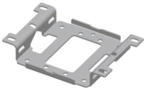
Piastra di fissaggio in acciaio zincato con kit bulloni M5. L'accoppiamento di due piastre permette il fissaggio a pali di diametro 40/60 mm.
