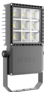
SMART[PRO] 2.0 è un proiettore LED di media potenza, per esterno e interno, adatto all'illuminazione di aree e impianti sportivi. Può essere installato a parete, a soffitto o a terra grazie alla staffa in acciaio zincato verniciato a polvere di poliestere con passivazione trivalente dotata di scala goniometrica regolabile, fornita in kit.
