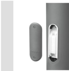
Palo conico per interramento in lamiera di acciaio spessore 3 mm zincato a caldo e verniciato a polveri poliestere. Dotato di due asole 46x186 mm per ingresso cavi e morsettiera di derivazione inclusa. Portella della morsettiera verniciata del colore del palo.
