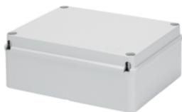
Gamma di cassette di derivazione stagne da parete serie 44 CE rispondenti alla norma ANSI/UL 50 e realizzate con tecnopolimeri ad elevate prestazioni. La gamma si compone di versioni IP56 con pareti lisce e con coperchi ciechi, bassi, a vite (GWT960°C).
