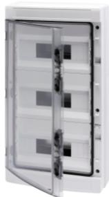
Gamma di centralini stagni IP65 da 8 a 72M, in versione con porta trasparente fumè ed equipaggiati con morsettiere a vite multipolari, 80 A IP20. Accorgimenti tecnici: fondi e frontali reversibili, telai e pannelli finestrati estraibili e portelle con apertura fino a 180° sganciabili ed accessoriabili con serratura di sicurezza. Le morsettiere consentono di realizzare un cablaggio semplice ed ordinato riducendo i tempi per la messa in opera del centralino.
