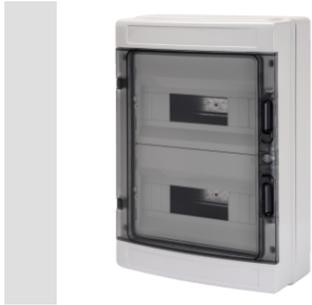
Gamma di centralini stagni IP65 da 8 a 72M, in versione con porta trasparente fumè ed equipaggiati con morsettiere a vite multipolari, 80 A IP20. Accorgimenti tecnici: fondi e frontali reversibili, telai e pannelli finestrati estraibili e portelle con apertura fino a 180° sganciabili ed accessoriabili con serratura di sicurezza. Le morsettiere consentono di realizzare un cablaggio semplice ed ordinato riducendo i tempi per la messa in opera del centralino.
