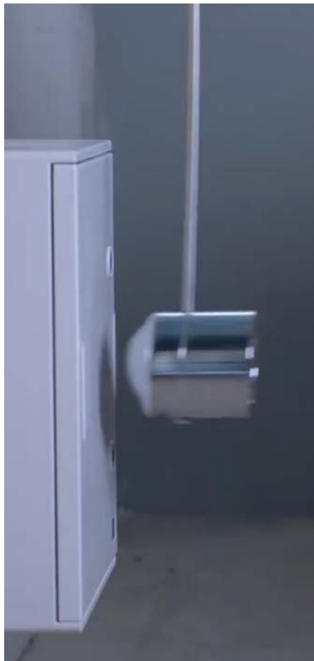
Ensayo impactos mecánicos IK
