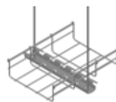
3 - Montaggio in bilancella. Aggiungere almeno 150 mm al dimensionamento della piastra. ad es.: piastra L 100 mm > attacco MV 51133 L 300 mm
