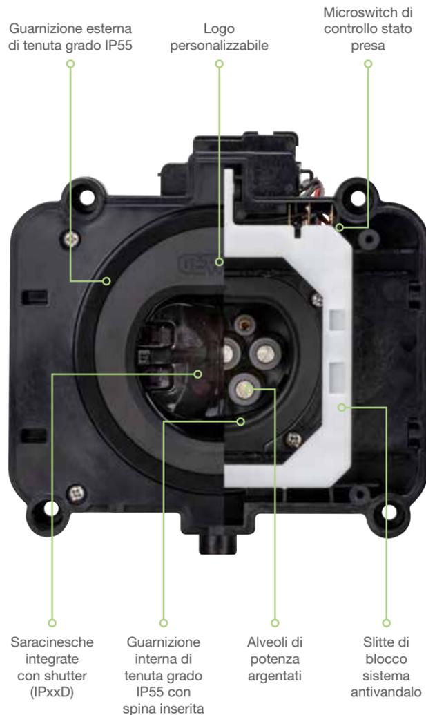
La presa è dotata di 3 micro-contatti per rilevare lo stato delle saracinesche (aperte o chiuse) e lo stato del blocco (attivo o non attivo). Nell'offerta sono disponibili anche versioni con **LED integrato**: 1) intermittente: che segnalano l'attivazione della presa; 2) RGB, che ne indicano lo stato: libera (luce verde), in uso (luce blu), errore (luce rossa).
