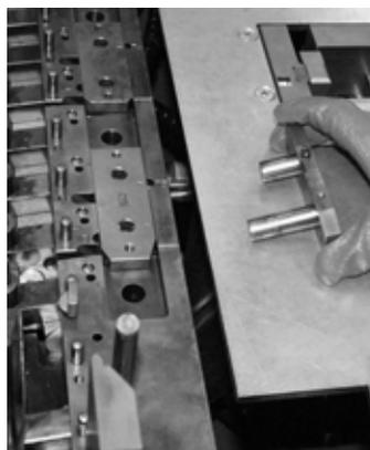
Figura 4.48 – Appoggio del primo fulcro 3 sul piano di lavoro
