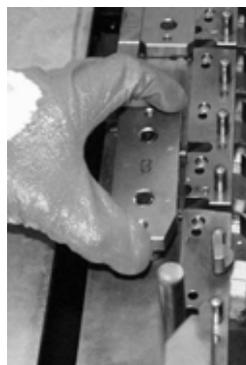
*Figura 4.51 – Posizionamento del secondo fulcro 3 di destra nel braccio posizione X3 a sinistra*
