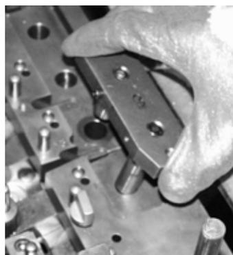
*Figura 4.54 – Posizionamento del fulcro 3 riposto a destra*
