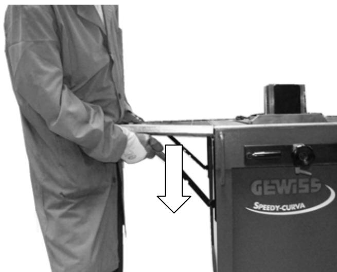
*Figura 3.11 – Sistema di fissaggio dei piani di appoggio*
