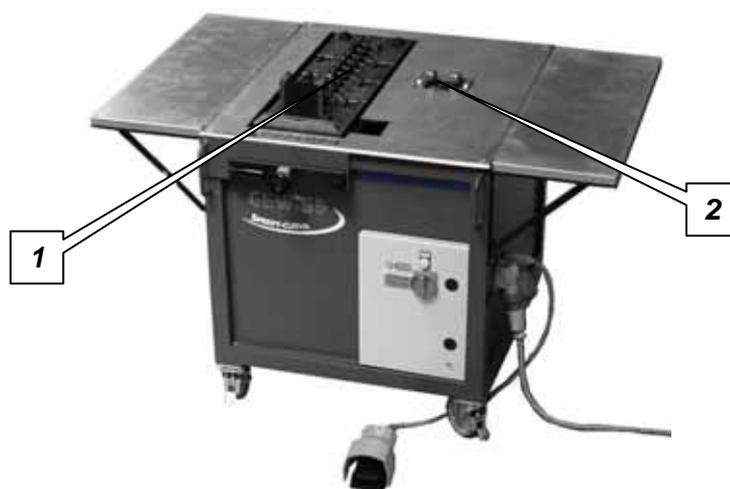
Figura 5.1 – Posizionamento della stazione di piega e di taglio
