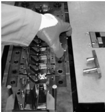
*Figura 4.50 – Estrazione del fulcro 3 di destra*
