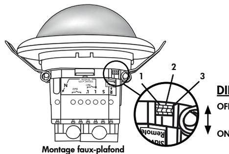
DIP 1 Mode autonome/semi-autonome
