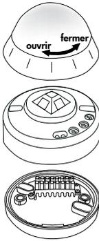
Le détecteur doit être monté sur une surface plane et solide. Enlever la lentille de fresnel, avant le montage en la dévissant d'env. 5° dans le sens inverse des aiguilles d'une montre et la retirer.
