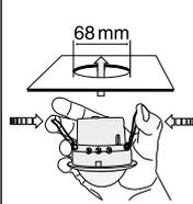
Ce détecteur a été développé spécialement pour l'installation dans des faux plafonds.
