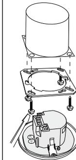
Le détecteur peut être monté au plafond dans des boîtiers simples.
