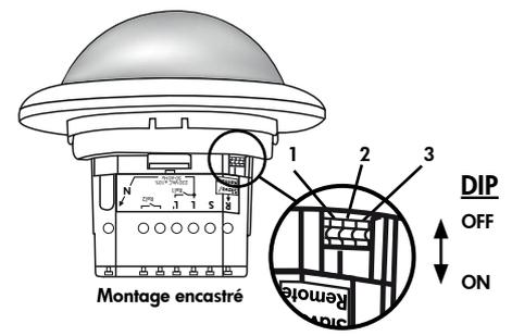
DIP 1 Mode autonome/semi-autonome
