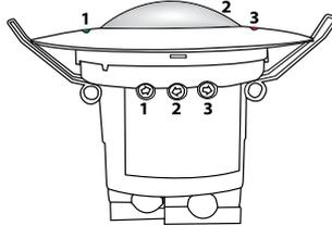
Potenciómetro 1 Canal 1 Lux
