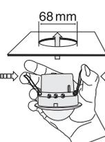
Para ello debe realizarse, previamente, un taladro de 68 mm de diámetro en el emplazamiento donde desee ubicarse el detector.
