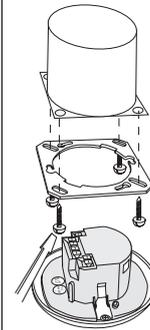
El detector está preparado para su montaje en techo utilizando un cajetín empotrable. Antes de iniciar el montaje debe desmontarse la placa de fijación incluida y atornillarla por el lado correcto al techo utilizando cuatro tornillos.
