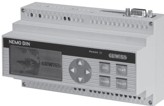
Il modulo **NEMO DIN PLUS** è alloggiato in un contenitore 9 moduli da guida DIN. È fornito di 4 linee LON RS485 (39 Kb/s) necessarie per comunicare con le lampade d'emergenza STARTEC NET Gewiss. L'interfaccia utente avviene tramite un display O-LED ed una tastiera a membrana. Il modulo **NEMO DIN PLUS** offre tutte le funzioni necessarie per:
