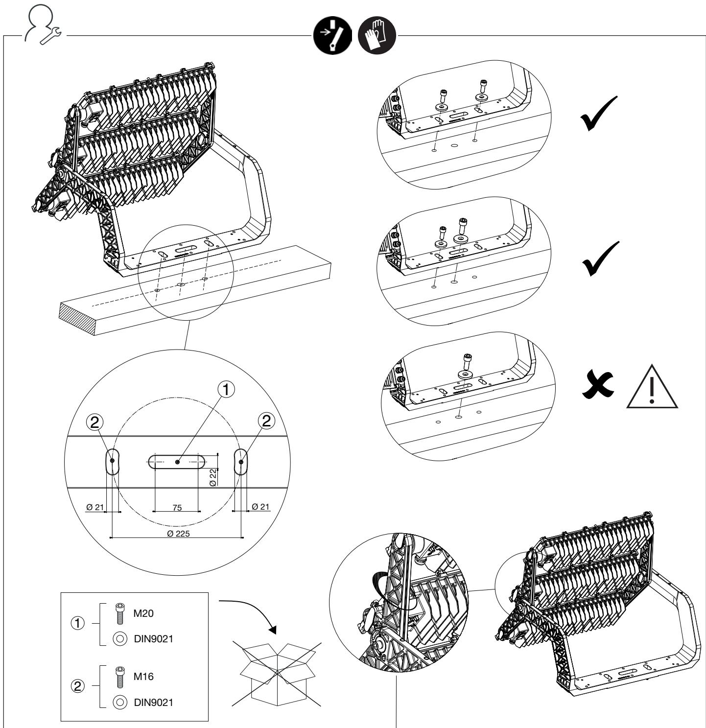
**IT** Per installazioni superiori a 3m assicurare il proiettore sulla spalla metallica con catena (es. GWS6922) o cavo di acciaio.
