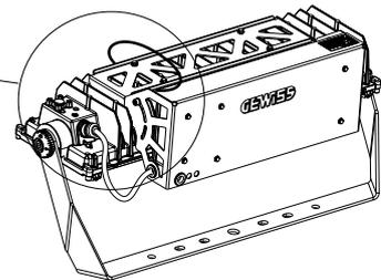
IT Per installazioni superiori a 3m assicurare il proiettore sulla spalla metallica con catena (es. GWS6922) o cavo di acciaio. -
