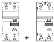
+ <b>minimum</b> | 1 x Interrupteur différentiel Type A réservé à la protection des circuits spécialisés suivants : <ul style="list-style-type: none"> <li>▪ cuisinière ou plaque de cuisson,</li> <li>▪ lave-linge,</li> <li>▪ prise ou borne de recharge pour véhicule électrique</li> </ul> 1 x Interrupteur différentiel Type AC ou A pour tous les autres circuits                                                                                |
