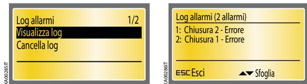
Figura 8.25 Alarm Log: mostra gli ultimi 20 allarmi, andando su Clear Log viene resettato il log
