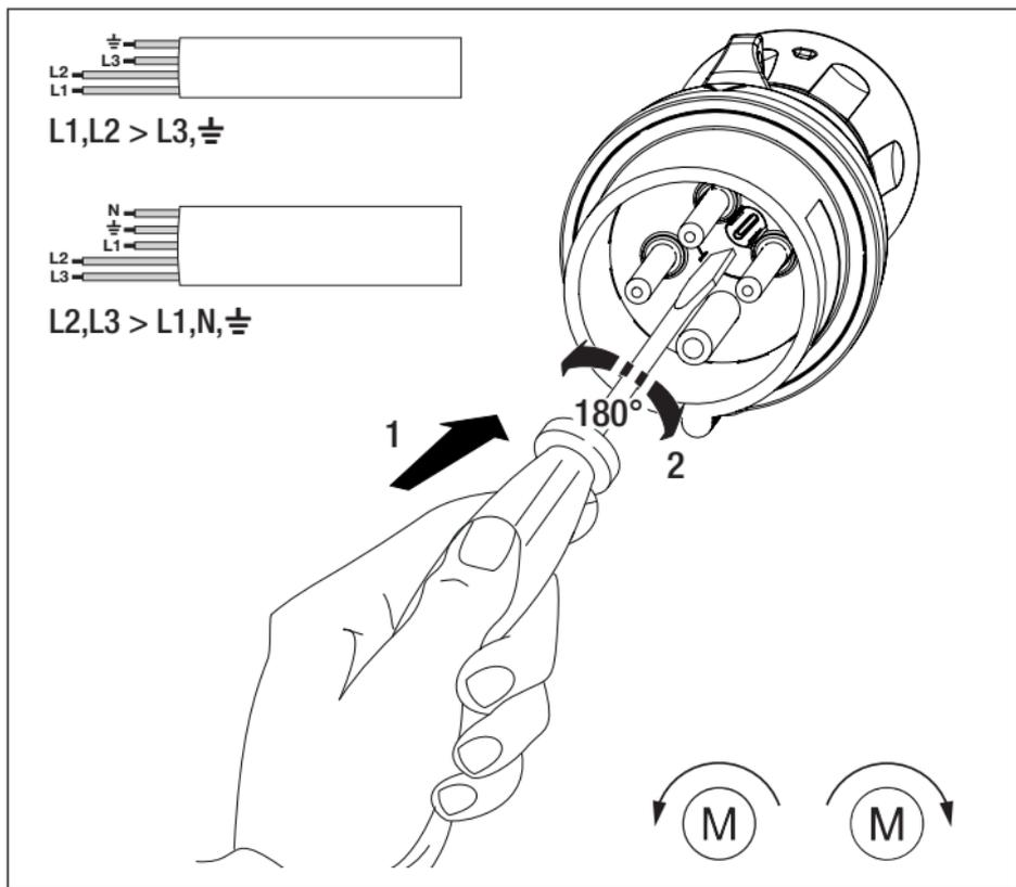
**IT:** Utilizzare solo conduttori flessibili di Classe 5 o 6 ed assicurarsi che i conduttori possano muoversi per permettere la manovra del dispositivo di inversione di fase.
