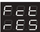
La pressione del tasto SET/MODE conferma l'operazione di reset e sul display compare la scritta "donE" per due secondi prima che il dispositivo si riavvii. La pressione dei tasti UP, DOWN annulla l'operazione e riporta il dispositivo nello stato di termine visualizzazione della versione firmware durante il riavvio.
