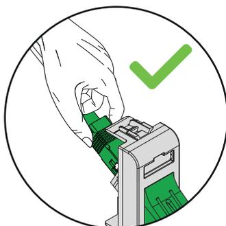
**PER LA CONNESSIONE IN BUSSOLA NON SOLLECITARE LA FIBRA NELLA PARTE DI TERMINAZIONE DEL CONNETTORE, MA AGIRE SEMPRE ED ESCLUSIVAMENTE SULL'IMPUGNATURA.**
