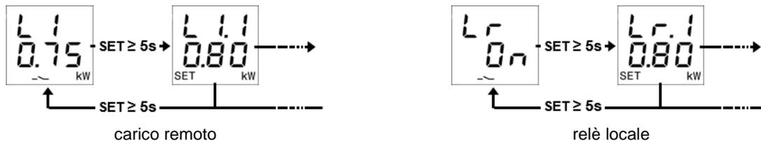
Nel menu SET, sui 3 digit in alto viene visualizzato il nome del primo parametro e sui tre digit in basso il suo valore corrente; attraverso i tasti "↑" e "↓" è possibile passare al parametro precedente/successivo e la pressione del tasto "SET" permette di accedere alla modifica del valore del parametro selezionato.
