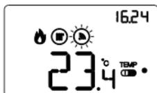
L'abilitazione dei comandi remoti permette di impostare da remoto il tipo e la modalità di funzionamento del termostato, ad esempio tramite il remotizzatore GSM Easy. Durante il normale funzionamento del termostato, alla ricezione di un comando da remoto, il simbolo  $\odot$  lampeggia finché la modalità attiva rimane quella impostata da remoto.
