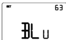
Utilizzare i tasti o per impostare il peso della componente blu (BLU) nella retroilluminazione del display (valore impostabile da 1 a 63). La regolazione è valida solo per il colore bianco dello schermo.
