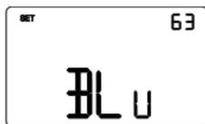
Utiliser les touches ou pour imposer le poids de la composante bleue (BLU) du rétro-éclairage de l'afficheur (valeur réglable de 1 à 63). Le réglage n'est valable que pour le blanc de l'écran.
