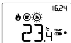
L'habilitation des commandes à distance permet d'imposer le type et la modalité de fonctionnement du thermostat, par exemple à travers le transmetteur GSM Easy. Lors du fonctionnement courant du thermostat, à la réception d'une commande à distance, le symbole clignote tant que la modalité active reste celle imposée à distance.
