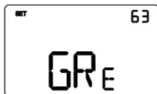
Utiliser les touches ou pour imposer le poids de la composante verte (GRE) du rétro-éclairage de l'afficheur (valeur réglable de 1 à 63). Le réglage n'est valable que pour le blanc de l'écran.
