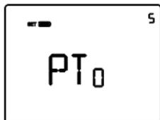
Si la fonction est habilitée, la pression de la touche  $\text{SET}$  permet d'accéder à la page d'imposition de la durée de la période d'inactivité et, à l'aide des touches  $\triangle$  ou  $\nabla$ , on pourra imposer l'intervalle (de 5 à 120 secondes). Pour confirmer le choix et passer au paramètre successif, appuyer sur la touche  $\text{SET}$  dans les 30 secondes.
