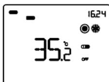
Die **Betriebsart Schutz vor hohen Temperaturen** ist nur im Kühlbetrieb aktiv, wenn die Temperaturregelanlage ausgeschaltet ist (OFF).
