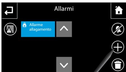
Premere il pulsante **+** e digitare sulla tastiera che apparirà un nome da assegnare all'allarme; premere il pulsante “invio” e scegliere dalla finestra che apparirà la logica che determina il verificarsi dell’“Allarme”.
