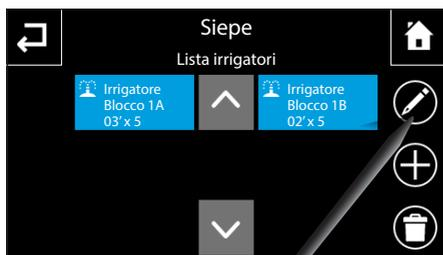
Al termine della programmazione sotto al nome di ogni irrigatore componente il ciclo di irrigazione, sarà visualizzato il tempo di irrigazione ed il numero di ripetizioni.
