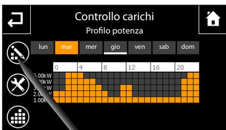
In questa sezione, viene visualizzato il diagramma consumi/ore che permette di impostare il consumo massimo ammissibile in una determinato periodo della settimana; in questo modo si possono sfruttare al massimo i vantaggi previsti dai contratti "a fasce orarie" proposti dai diversi fornitori di energia elettrica.
