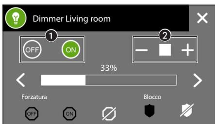
È anche possibile impostare la percentuale di dimmeraggio del punto luce sul cursore centrale: nella parte superiore della barra viene visualizzato il valore impostato. La barra diventa di colore bianco quando il valore impostato viene raggiunto.
