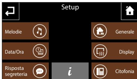
Premendo sul pulsante "Display" si accede ad una schermata che permette di regolare la luminosità del display.
