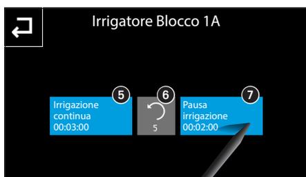
Premendo il pulsante **5** si attiva la tastiera per l'impostazione del tempo continuo d'irrigazione senza pause, ossia la durata di funzionamento dell'irrigatore ogni volta che viene attivato dal ciclo di irrigazione.
