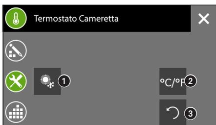
1. Pulsante per variare il tipo di funzionamento (raffrescamento / riscaldamento)
