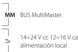
Para permitir el funcionamiento sincronizado de varios Videoporteros Naxos en una misma vivienda (función opcional), es necesario que estén conectados entre sí mediante el bus MultiMaster.
