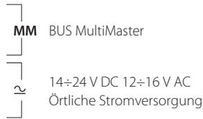
Für den synchronisierten Betrieb mehrerer Videosprechanlagen Naxos im gleichen Gebäude (optionale Funktion) müssen sie untereinander mit dem der Busleitung MultiMaster verbunden sein.
