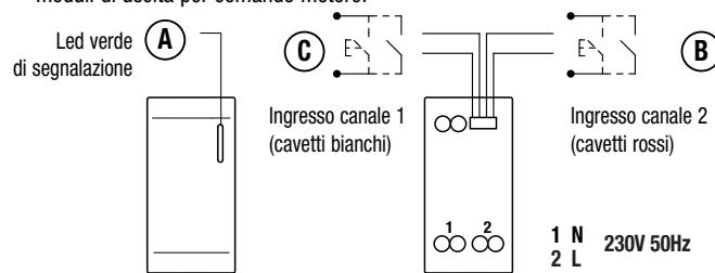
Il modulo è dotato di un led verde (A) di segnalazione. I due ingressi (B-C) sono dedicati al collegamento di contatti, privi di potenziale, di apparecchi di comando (pulsanti, interruttori, sensori, ecc.). Il modulo è alimentato a 230 V.
