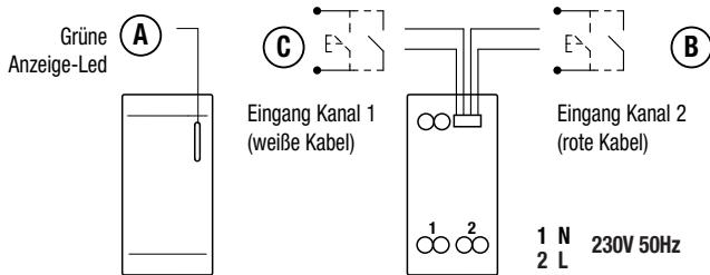
Das Modul ist mit einer grünen Anzeige-Led (A) ausgestattet. Es handelt sich um zwei Eingänge (B-C) zum Anschluss von potentialfreien Kontakten, Steuergeräten (Taster, Schalter, Sensoren, usw.). Das Modul muss an eine Leitung 230 V angeschlossen werden. Ein Drehschalter (D) ermöglicht die Wahl der Betriebsmodalität, die für beide Eingangskanäle gilt.
