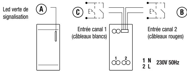
Le module est doté d'un led verte (A) de signalisation. Les deux entrées (B-C) sont dédiées à la connexion de contacts, sans potentiel, d'appareils de commande (poussoirs, interrupteurs, capteurs, etc.). Le module est alimenté à 230 V. Un sélecteur rotatif (D) permet de choisir le mode de fonctionnement, valable pour les deux canaux d'entrée.
