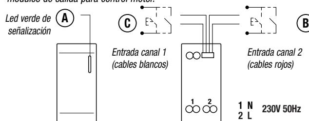
El módulo está dotado de un led verde (A) de señalización. Las dos entradas (B-C) están especializadas en la conexión de contactos, sin potencial, de aparatos de control (pulsadores, interruptores, sensores, etc). El módulo está alimentado a 230 V. Un selector giratorio (D) permite la elección de la modalidad de funcionamiento, válida para ambos canales de entrada.
