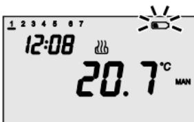
Wenn die Batterien sich kurz vor deren Erschöpfung befinden, beginnt auf dem Display das Symbol zu blinken. Der Betrieb des Chronothermostats wird auf jeden Fall gewährleistet. In diesem Fall müssen die Batterien so bald wie möglich ausgetauscht werden.
