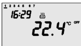
Der **Frostschutzbetrieb** ist nur im Heizzustand aktiv. In dieser Fall verwendet der Chronothermostat den eingestellten Frostschutz Temperatur-Bezugswert. Auf dem Display erscheint OFF und die gemessene Umgebungstemperatur.
