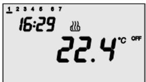
Il **funzionamento antigelo** è attivo solo in riscaldamento. In questo caso il cronotermostato utilizza il set point di temperatura antigelo impostato.
