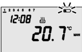
Quando le batterie sono in fase di esaurimento, sul display inizia a lampeggiare il simbolo .
