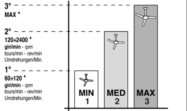
\* Velocità media di rotazione, variabile in funzione della potenza del motore ed il diametro delle giranti
