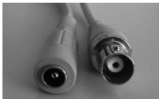
La telecamera è dotata di un cavo a Y, della lunghezza di circa 35 cm, intestato ad un'estremità con connettore BNC femmina per il collegamento al segnale video e all'altra estremità con spina coassiale maschio ( $\varnothing$ interno 2,1 mm,  $\varnothing$ esterno 5,5 mm, lunghezza 11 mm - positivo al centro) per l'alimentazione 12Vdc.
