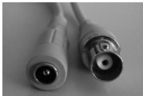
La telecámara está dotada de un cable en Y, con una longitud de aproximadamente 35 cm, equipado en un extremo con un conector BNC hembra para la conexión a la señal vídeo y en el otro extremo con clavija coaxial macho ( $\varnothing$  interior 2,1 mm,  $\varnothing$  exterior 5,5 mm, longitud 11 mm - positivo en el centro) para la alimentación 12Vcc.
