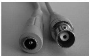
La caméra est munie d'un câble en Y, d'une longueur d'environ 35 cm, présentant d'un côté un connecteur BNC femelle pour le raccordement au signal vidéo et, de l'autre, une fiche coaxiale mâle ( $\emptyset$  interne 2,1 mm,  $\emptyset$  externe 5,5 mm, longueur 11 mm, positif au centre) pour l'alimentation 12 Vcc.
