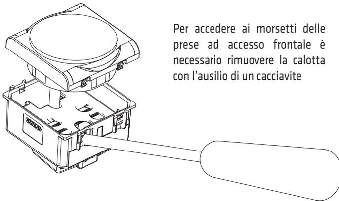
Per accedere ai morsetti delle prese ad accesso frontale è necessario rimuovere la calotta con l'ausilio di un cacciavite
