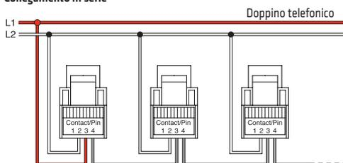
\* I morsetti 3 e 4 sono collegati tramite il contatto interno al telefono che è chiuso a ricevitore agganciato. Lo sgancio del ricevitore determina l'interruzione della linea a valle (polo L1) garantendo il segreto di conversazione.
