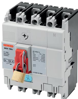
Dispositivi che bloccano la leva permettono di bloccare l'interruttore nella posizione ON o OFF usando fino a tre lucchetti. I dispositivi di blocco per i modelli 125A, 160A e 250A accettano lucchetti con diametro di 5mm. Dispositivi di blocco per modelli 400A fino a 1600A accettano lucchetti avente diametro di 8mm.
