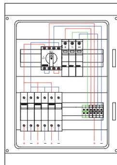
Cuadro precableado para la conexión de 3 cadenas de módulos fotovoltaicos al inversor, compuestos por:
