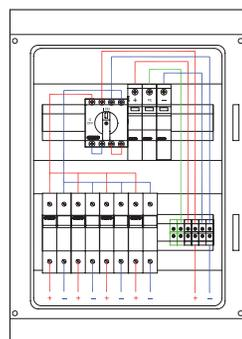
Cuadro precableado para la conexión de 4 cadenas de módulos fotovoltaicos al inversor, compuestos por:
