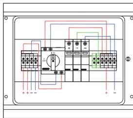
Cuadro precableado para la conexión de 1 ó 2 cadenas de módulos fotovoltaicos al inversor, compuestos por:
