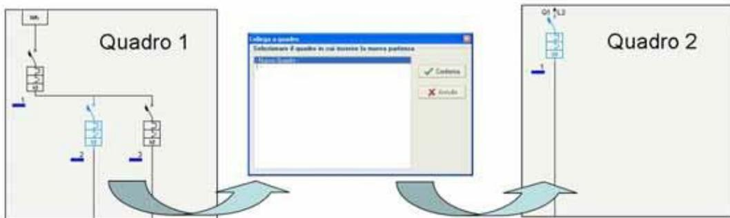
NB: sulla partenza inserita nel nuovo quadro (quadro 2) sono indicati il quadro (Q1) e la linea di provenienza del collegamento (L2)
