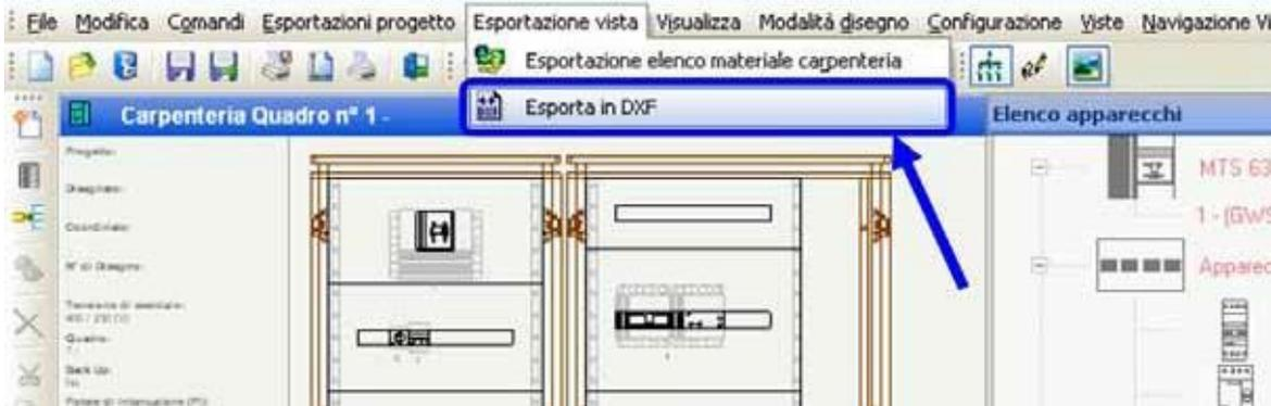
Nota: l'esportazione diretta in DXF ha il vantaggio di generare un file di dimensioni minori rispetto a quella ottenuta mediante l'anteprima di stampa
