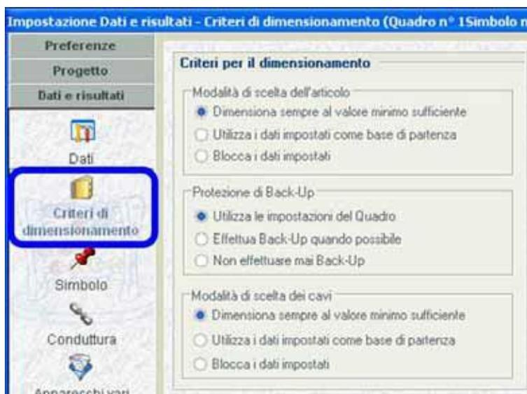
è possibile impostare vari criteri di dimensionamento, ovvero definire delle regole che il programma deve rispettare in fase di calcolo.
