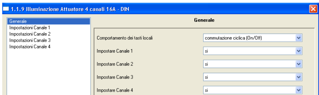
Fig. 56: Finestra di configurazione parametri Attuatore 4 canali (11) – Generale
