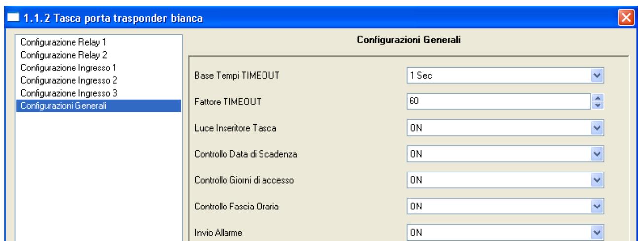
Fig. 15: Finestra di configurazione parametri Tasca transponder (3) – Configurazioni Generali
