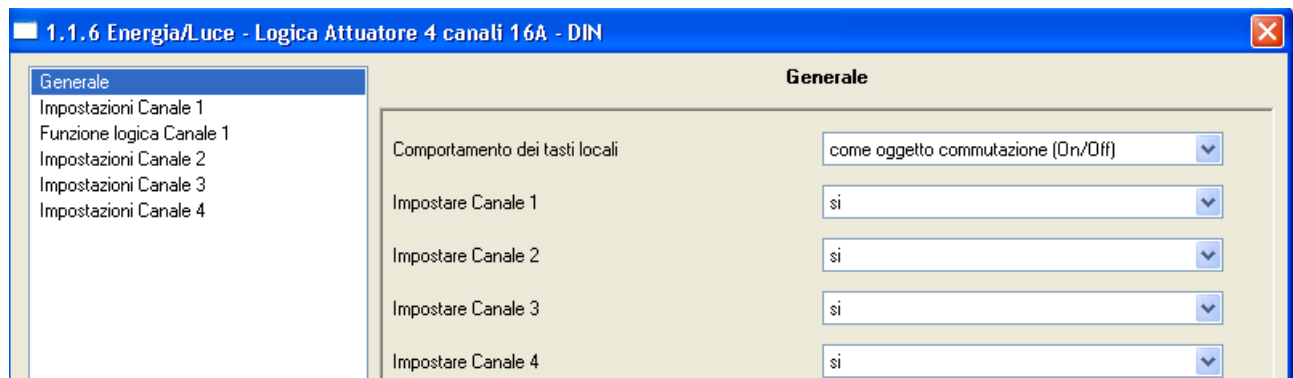
Fig. 29: Finestra di configurazione parametri Attuatore 4 canali 16A (5) – Generale
