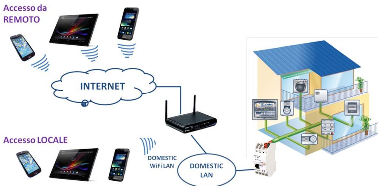
L'interfaccia KNX/IP è collegata alla rete domestica attraverso il modem-router, il collegamento è realizzato via cavo.
